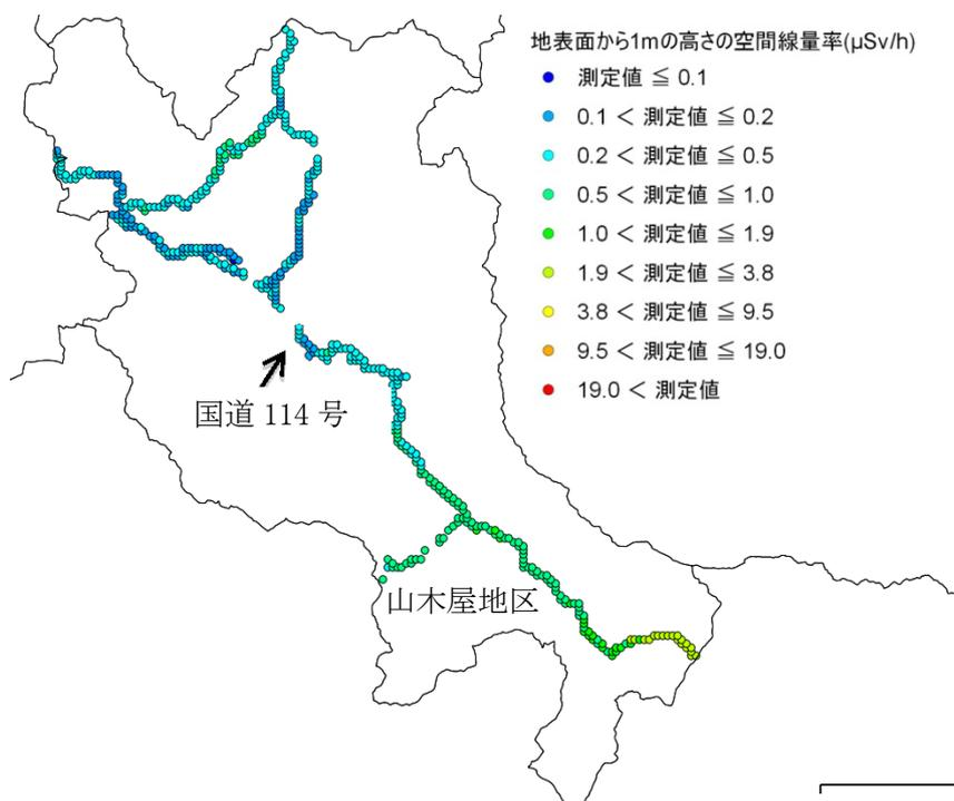
図-1 平成 25 年 5 月の走行サーベイによる空間線量率測定結果
